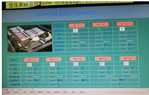
▲索尼数字产品（无锡）有限公司运用 IoT 技术，在洁净室负荷较低的状况下，系统自动识别并调整组合式空调机的运转频率，实现年节约能源 490,000kwh
